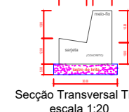
Detalhe do Meio-Fio com Sarjeta (GER Tipo 2 - 0,042 m/m) (medidas em centímetros)
